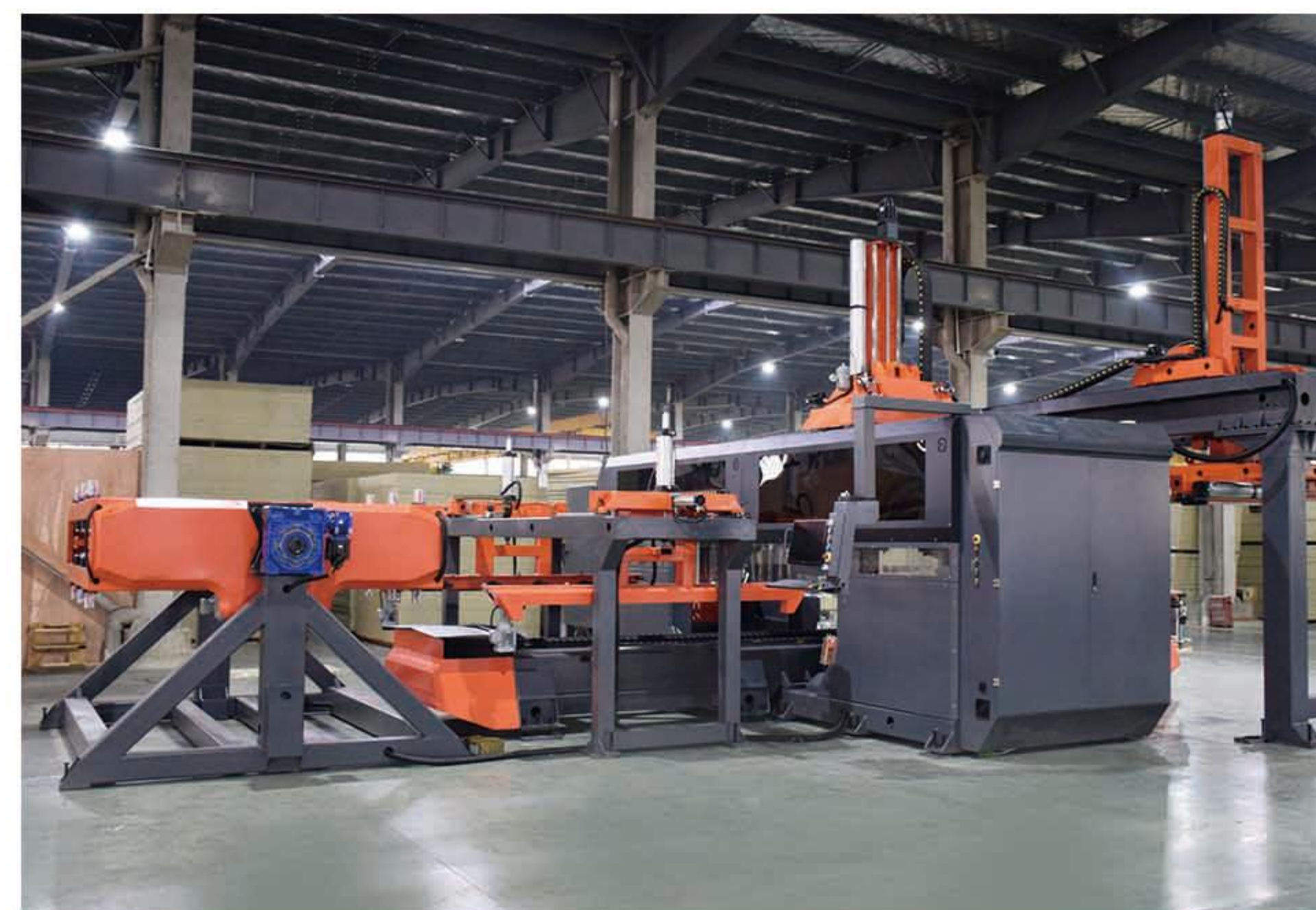
Five-axis processing line for filter plate Linha de processamento de cinco eixos para placa de filtro
