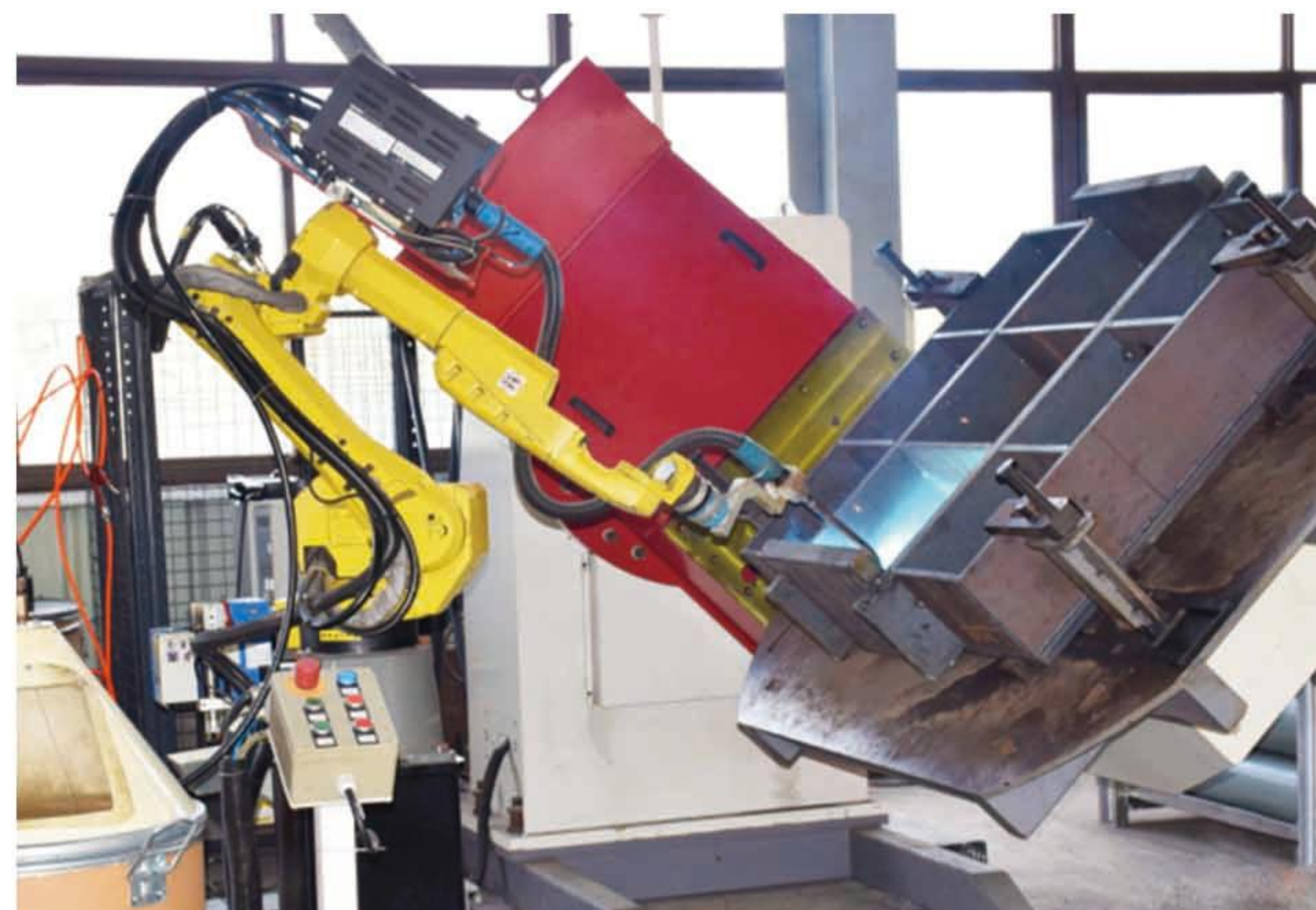
Robot welding machine Máquina de solda por robô
