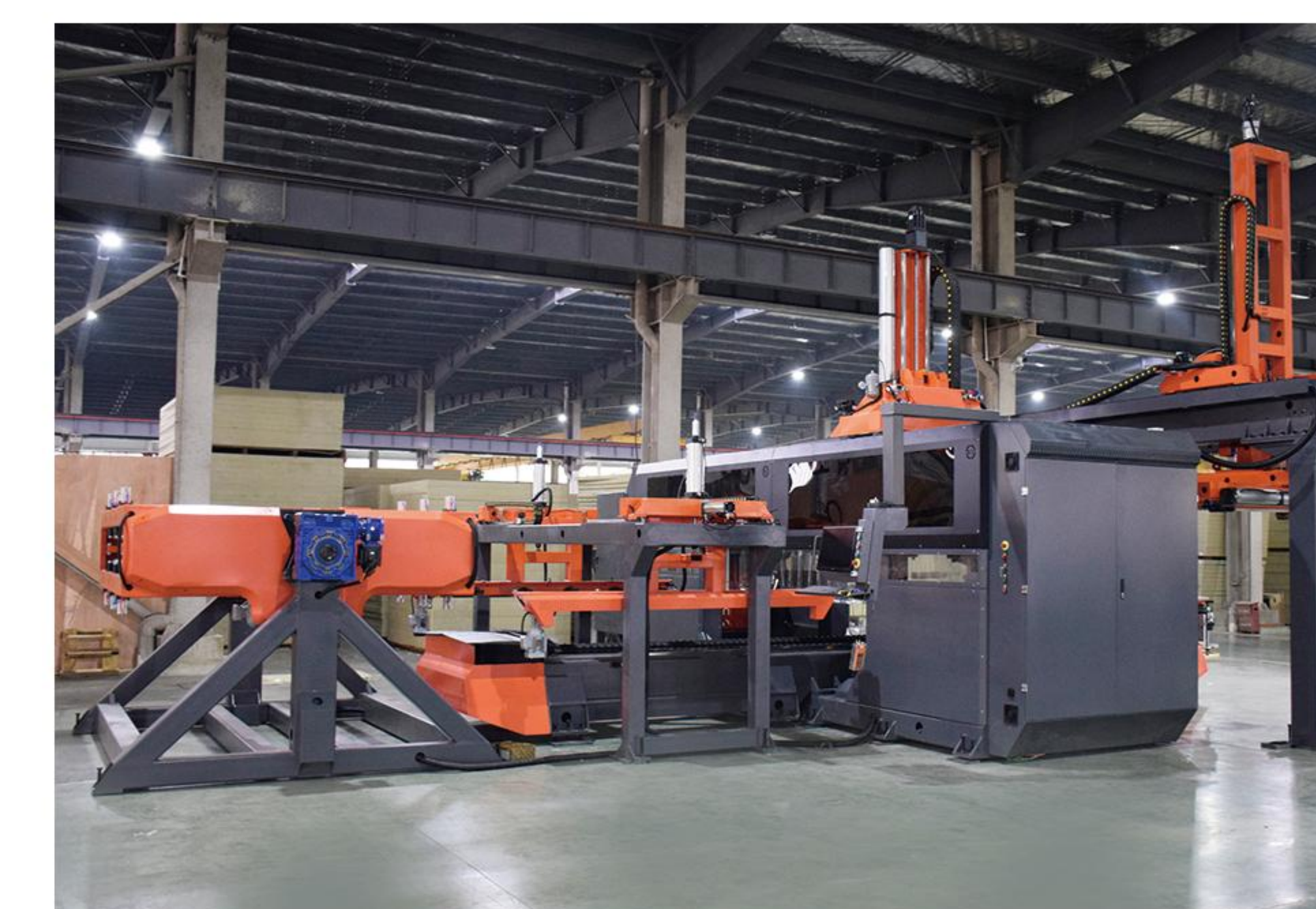
Five-axis processing line for filter plate Линия обработки фильтрующей пластинки по пяти осям
