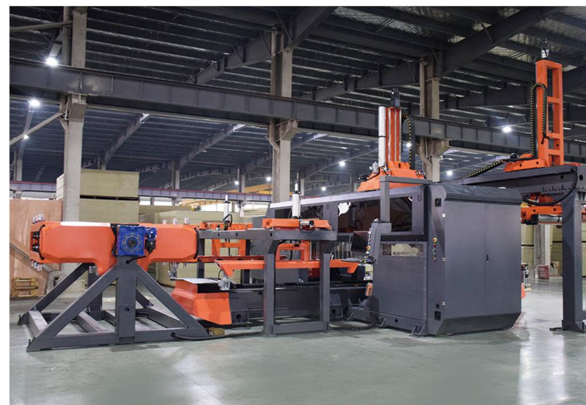
Five-axis processing line for filter plate Centro de procesamiento de placas de filtración de cinco ejes
